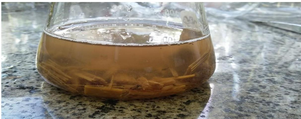
Figura 12: Água com bagaço seco após 3 dias de dessorção.
