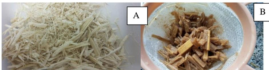
Figura 10: Bagaço seco (A) antes e (B) após o ensaio de 7 dias sorção em vinhaça.
