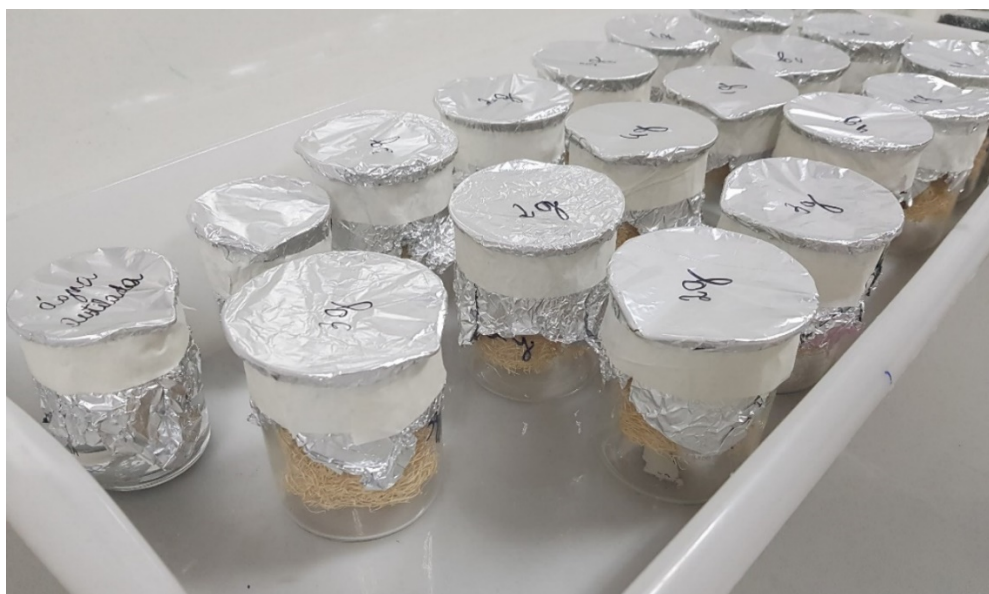
Figura 4 – Conjunto de reatores identificados pela massa de biofiltro, prontos para esterilização.
