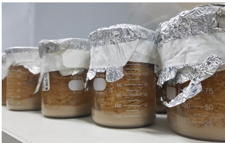
Figura 6 – Camada de lodo residual decantada no fundo dos reatores após o ensaio de tratamento de 24 horas.
