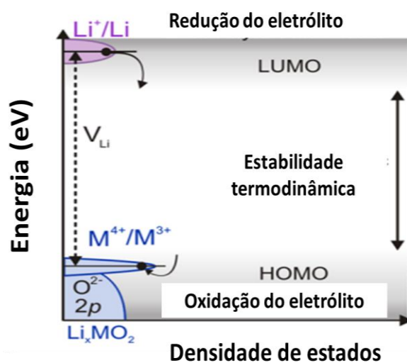
Figura 11. Comparação entre os potenciais de uma bateria e o intervalo de estabilidade do eletrólito.
