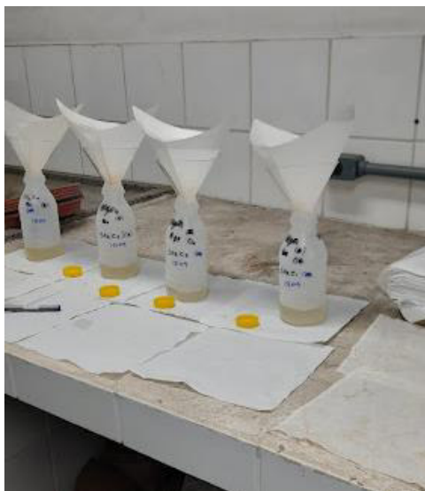
Figura 3 - Realização da filtração do material lixiviado (A) e armazenamento das amostras em frascos de polietileno (B).
